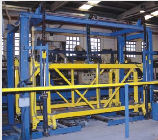
Fig. 4: (Des)Apilador de cestas TECALEX
