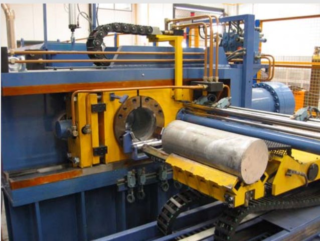
Fig. 7) Cisaille à chaud TECALEX de haute précision
