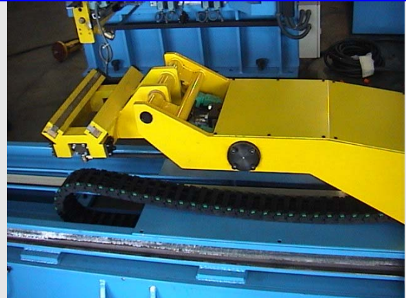
Fig. 8) Alimentador a prensa con bandeja móvil
