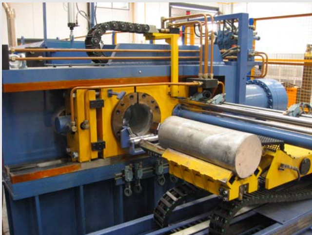
Fig. 7) Cizalla en caliente TECALEX de gran precisión
