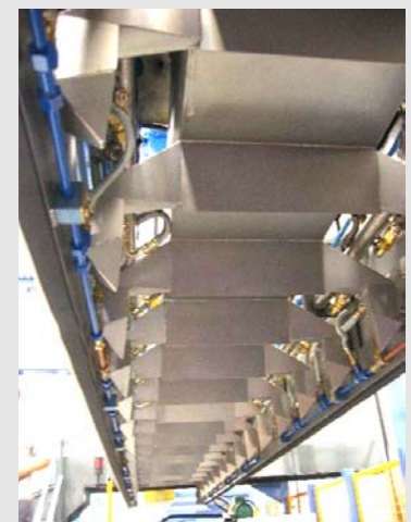
Fig. 6) Anpassung der Düsen an verschiedene Profile
