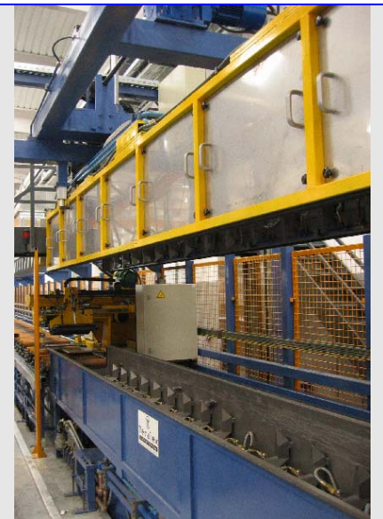
Fig. 3) Mesa de enfriamiento en planta de extrusión de 2200MT
