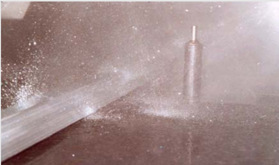
Fig. 5) Perfil durante el enfriamiento por agua
